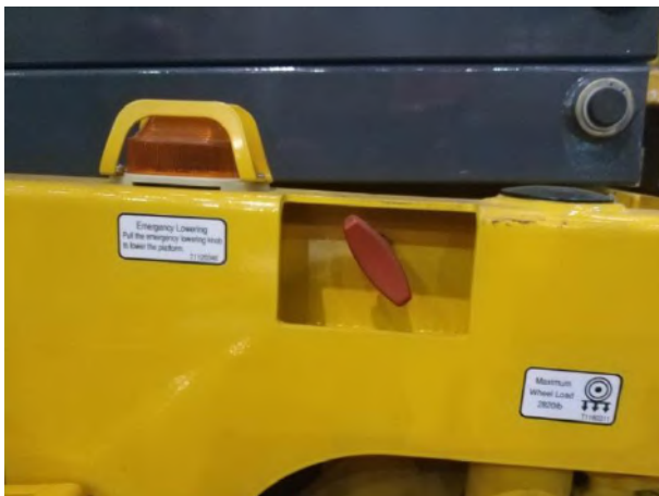
Fig. 4-1 De positie van het handmatig bedieningsgedeelte
