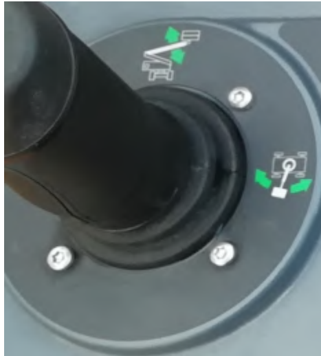
Afb. 5-4 Proportionele bedieningshendel met dubbele assen - links
