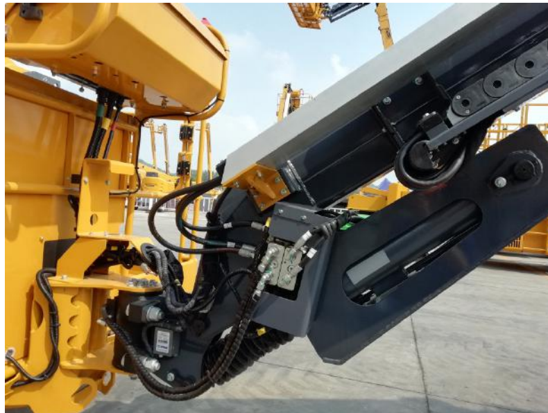
Afb. 6-6 Hydraulische slangen op het platform
