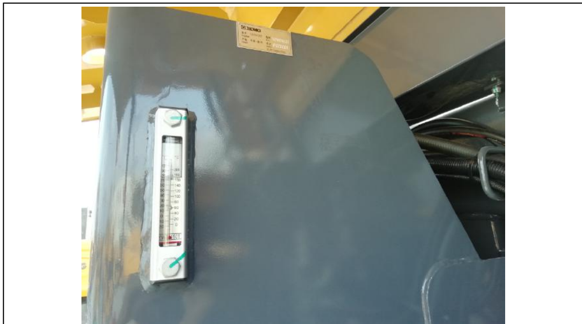
A f b . 6-2 Indicator hydrauliekoliepeil en temperatuur in de hydrauliekolietank
