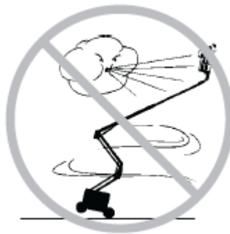
Afbeelding 2-9 Het is verboden om te werken bij harde wind.
