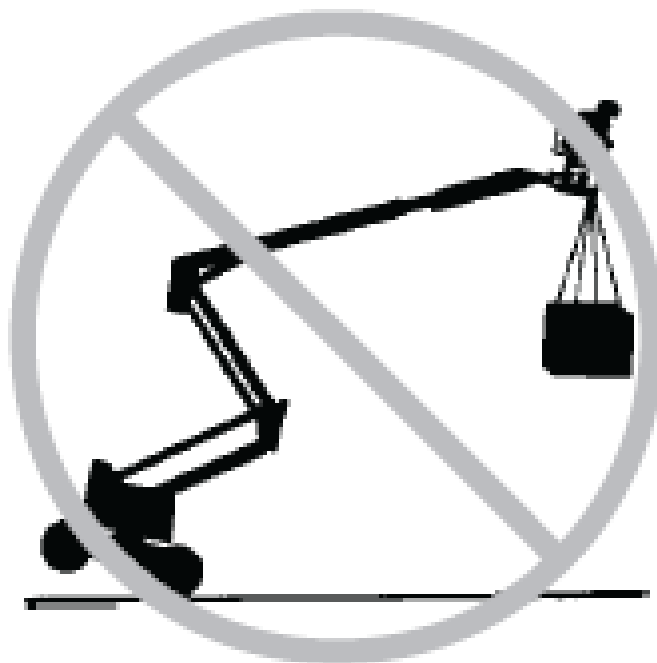
Afbeelding 2-7 Het is verboden om enige last te plaatsen of op te hangen.
