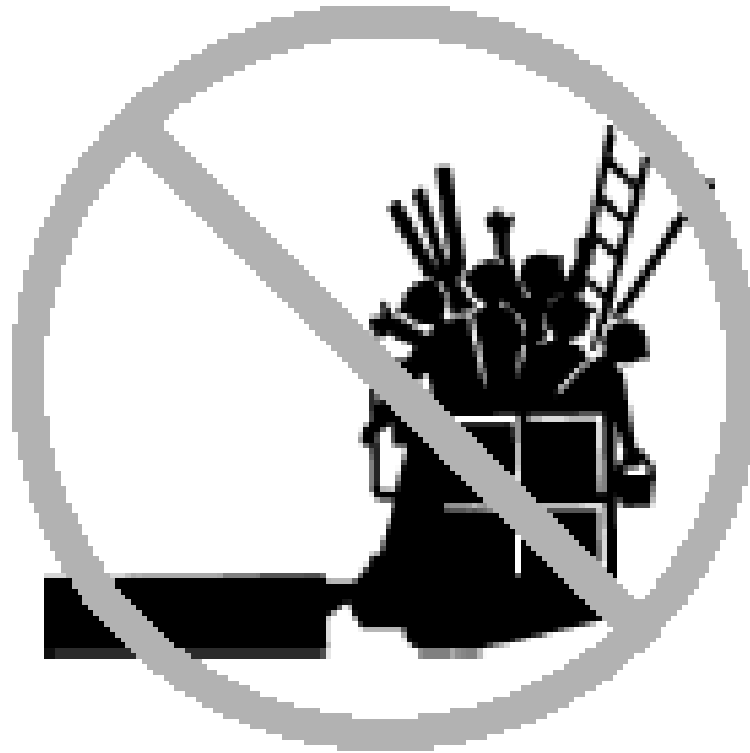
Afbeelding 2-8 Het is verboden om een ladder of steiger te plaatsen.
